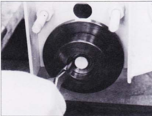
③ 輪軸に止められているストップリングをプライヤーで抜き取ります。
